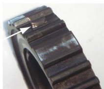
Износ узкого зуба в виде скола, потертости. Замена обязательна!!!!
