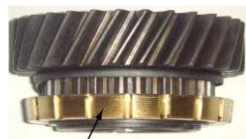
Клинья синхронизатора, пружины смазать перед сборкой маслом
