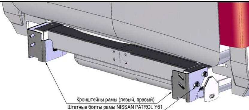
Далее устанавливаем кронштейны бампера как показано на рисунке левый и правый соответственно. Установку кронштейнов производить штатными болтами М14 (остались после снятия защиты штатного пластикового бампера). **БОЛТЫ НЕ ПРИТЯГИВАТЬ ДО КОНЦА!** Кронштейн должен свободно ходить по трубе рамы. Это необходимо сделать для последующей регулировки бампера при установке
