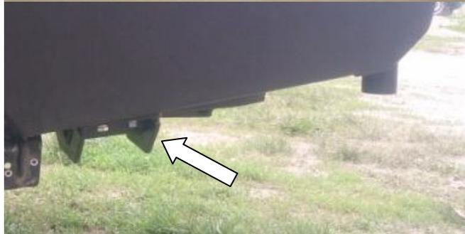
Далее устанавливаем боковые кронштейны бампера с двух сторон используя закладную. Закладные согнуть и убрать в бампер.
