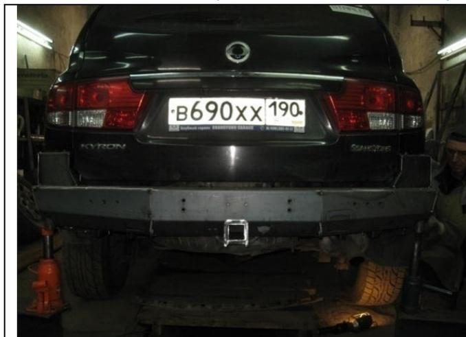
Затем навешиваем бампер на кронштейны рамы через болты М12х40 и увеличенные шайбы и затягиваем (НЕ ДО КОНЦА!) при помощи гаек М12 с шайбами.
