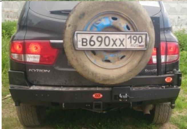
Регулируем бампер по центру (задняя дверь должна открываться без задеваний) выставляем зазор между кузовом и бампером 10-15 мм, путем перемещения болтов бампера по пазам. Затягиваем все гайки.
