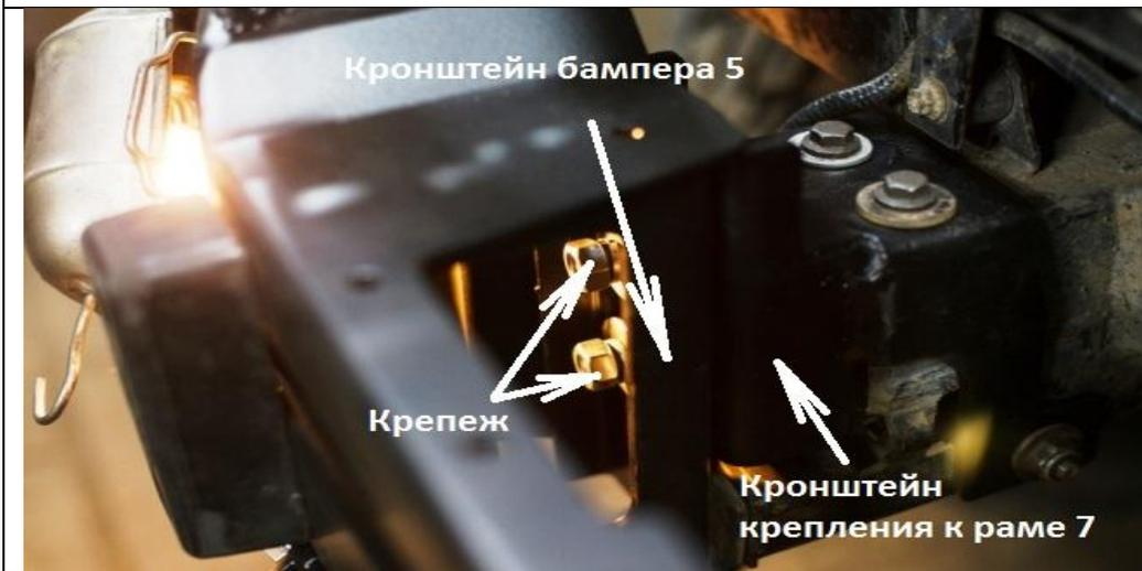
Совместить кронштейны бампера 5 с кронштейнами крепления к раме 7. Закрепить с помощью прилагаемого крепежа.
