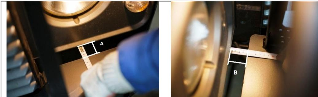
Выровнять бампер относительно кузова автомобиля.
