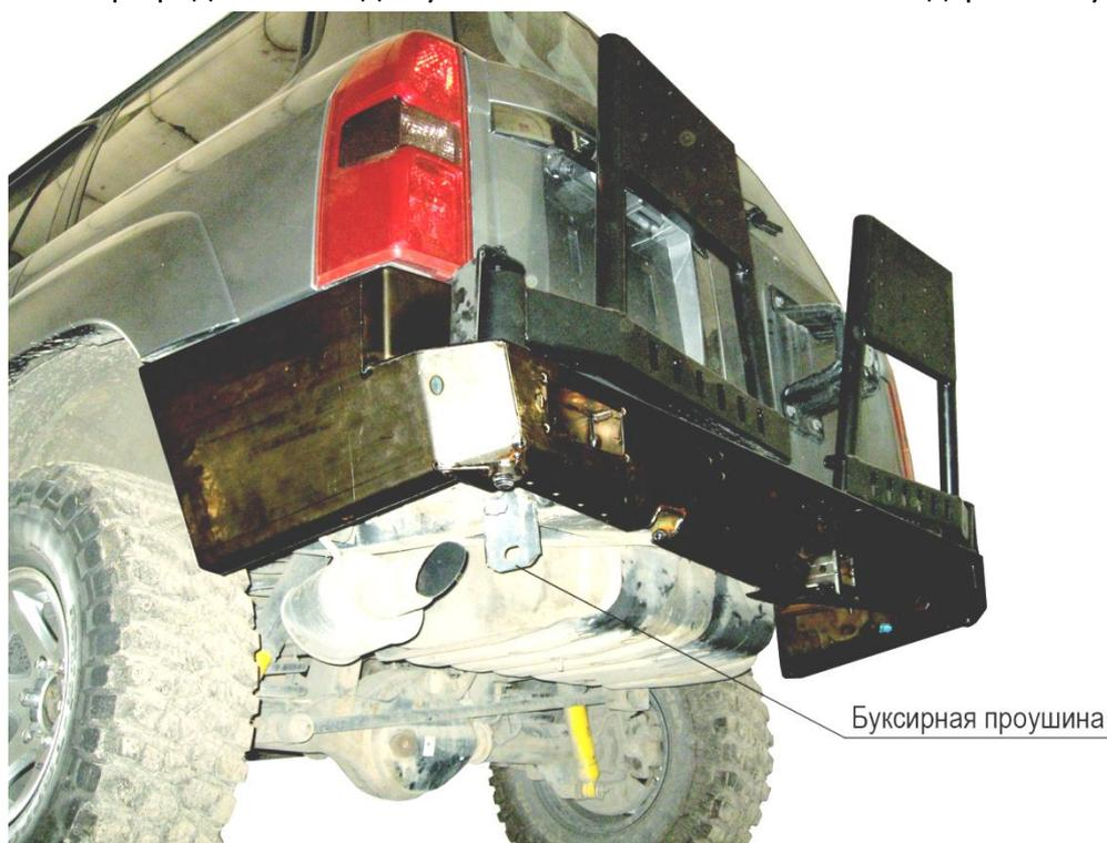
*Рис.4 Расположение буксирной проушины\* под бампером на раме внедорожника.*
