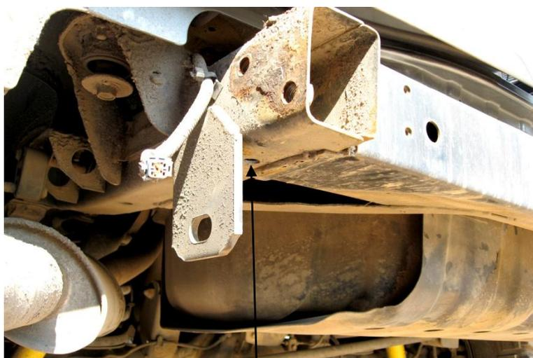
Отверстие для установки закладной пластины
